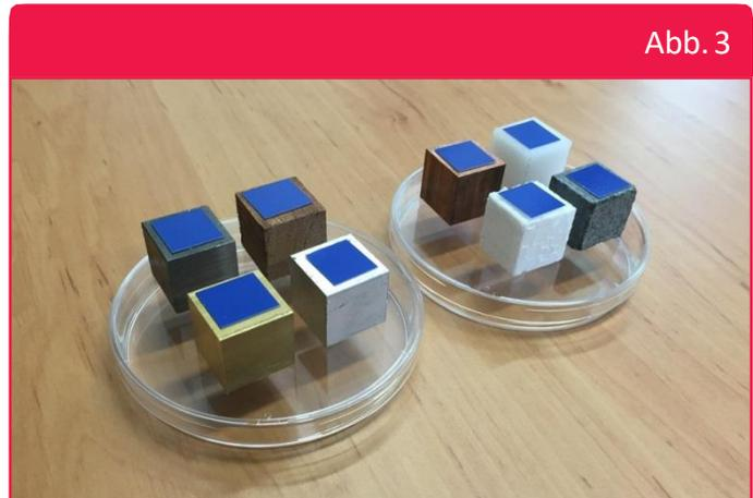
↑ Versuchsaufbau zum Ermitteln der Wärmeleitfähigkeit
