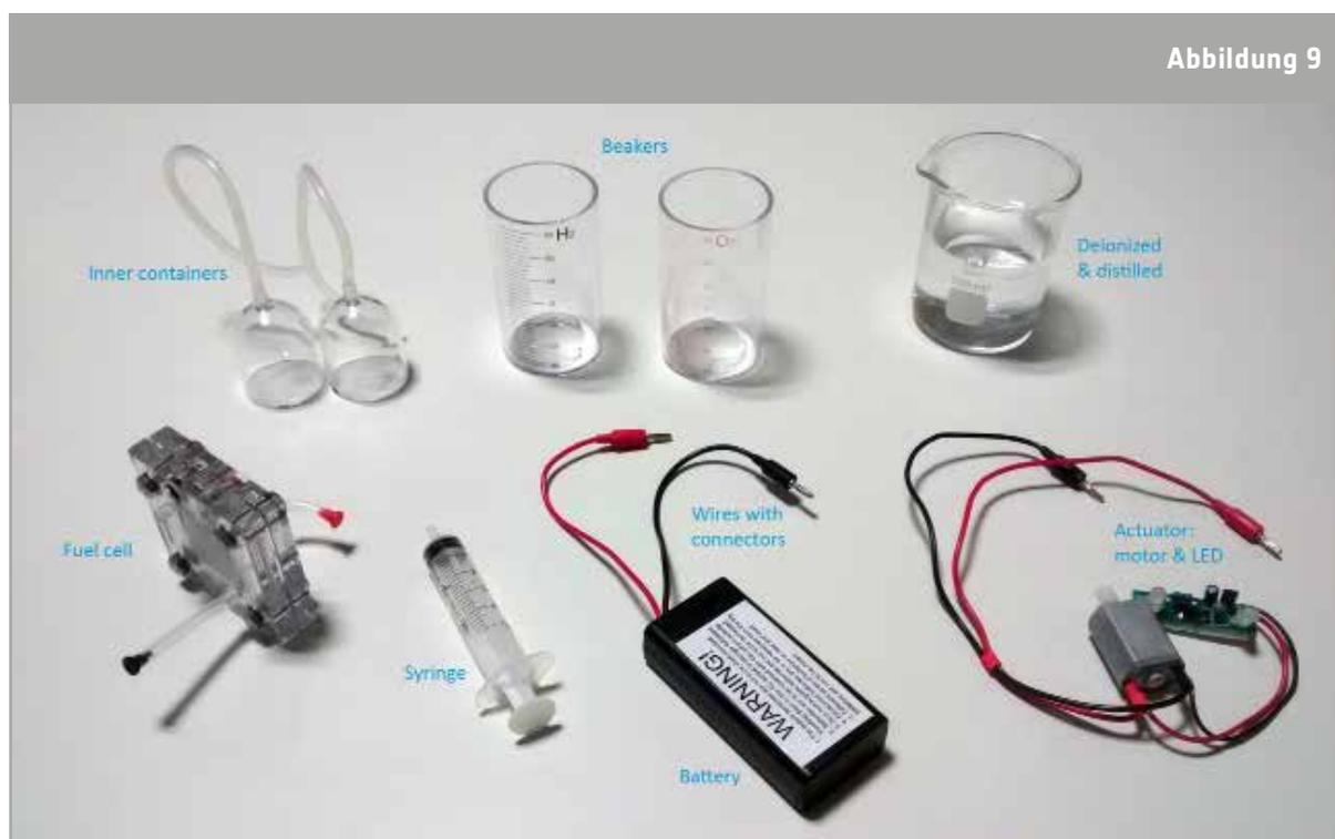
↑ Zum Bau eines Brennstoffzellensystems benötigtes Versuchsmaterial: Spritze, Brennstoffzelle, Bechergläser, Drähte mit Anschlüssen, Aktuatoren (Motor, LED), Deionisiertes und destilliertes Wasser, Batterie, Innenbehälter
