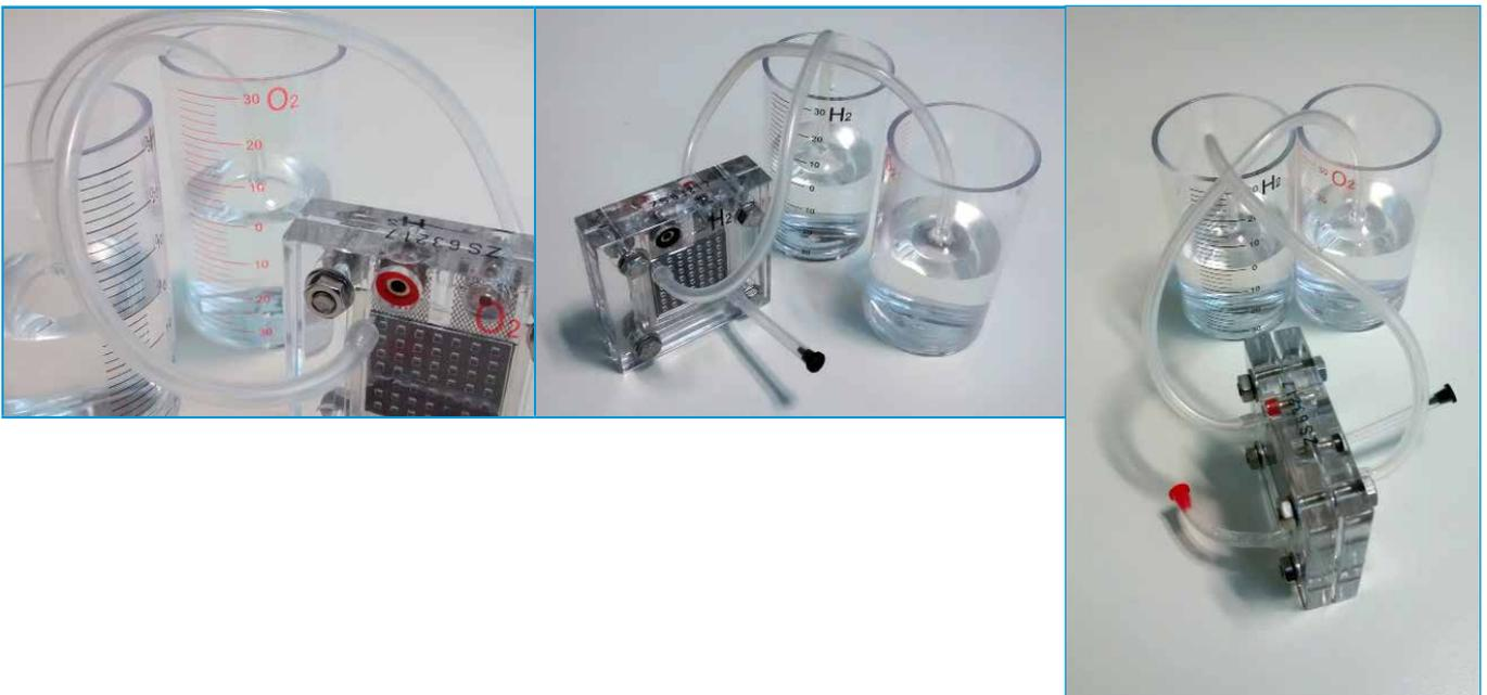
5. Schließt den Batteriesatz wie unten gezeigt an. Schaltet den Batteriesatz auf Stellung „ein“, und die Elektrolyse sollte beginnen.
