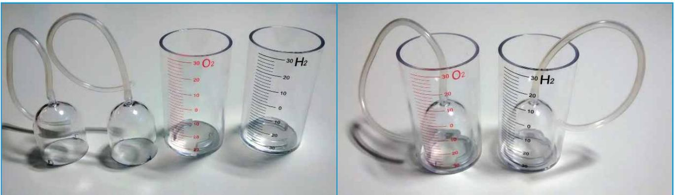
4. Verbindet die Silikonröhrchen mit den oberen Öffnungen der O<sub>2</sub>- und H<sub>2</sub>-Seite der Brennstoffzelle.
