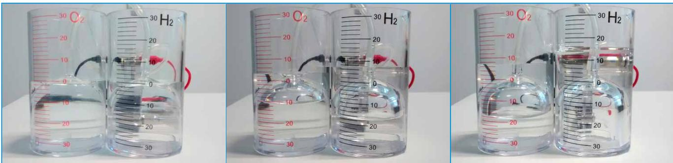
5. Trennt die Batterie ab und schließt einen Aktuator (Auto, Motor, LED usw.) an.  $H_2$  und  $O_2$  zusammen produzieren wieder  $H_2O$  und Energie zum Antrieb des Motors.
