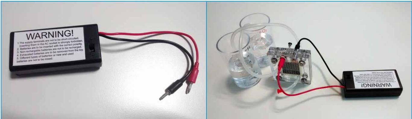
6. Beobachtet, wie sich die Innenbehälter allmählich mit  $H_2$  und  $O_2$  füllen. Wenn  $H_2$  allmählich in Blasen aus dem Behälter austritt, ist der Tank voll.
