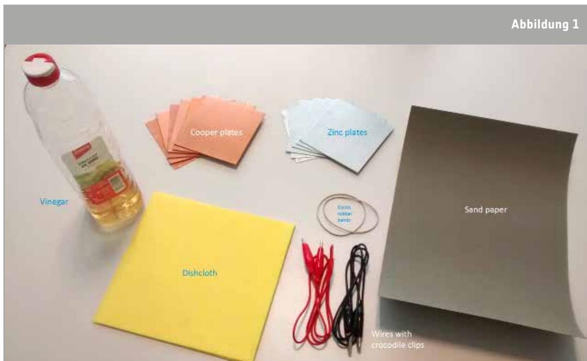
↑ Zum Bau einer Volta'schen Säule benötigtes Versuchsmaterial: Essig, Kupferplatten, Zinkplatten, Geschirrtuch, Drähte mit Krokodilklemmen, Schleifpapier, Gummibänder.
