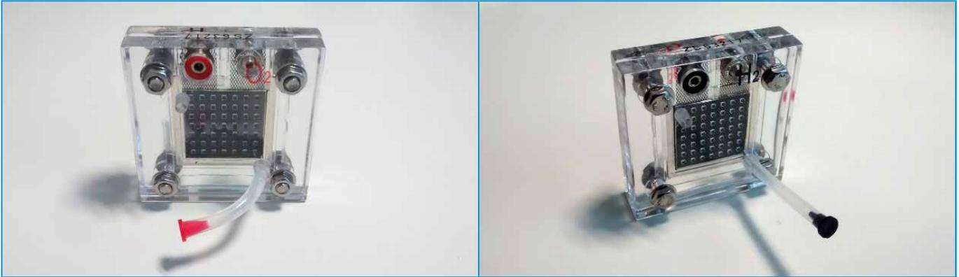
2. Entfernt den roten Stopfen von dem Röhrchen, das an die Sauerstoffseite der Brennstoffzelle angeschlossen ist. Injiziert mit der Spritze destilliertes Wasser in die Brennstoffzelle, bis sie zur Hälfte mit Wasser gefüllt ist.
