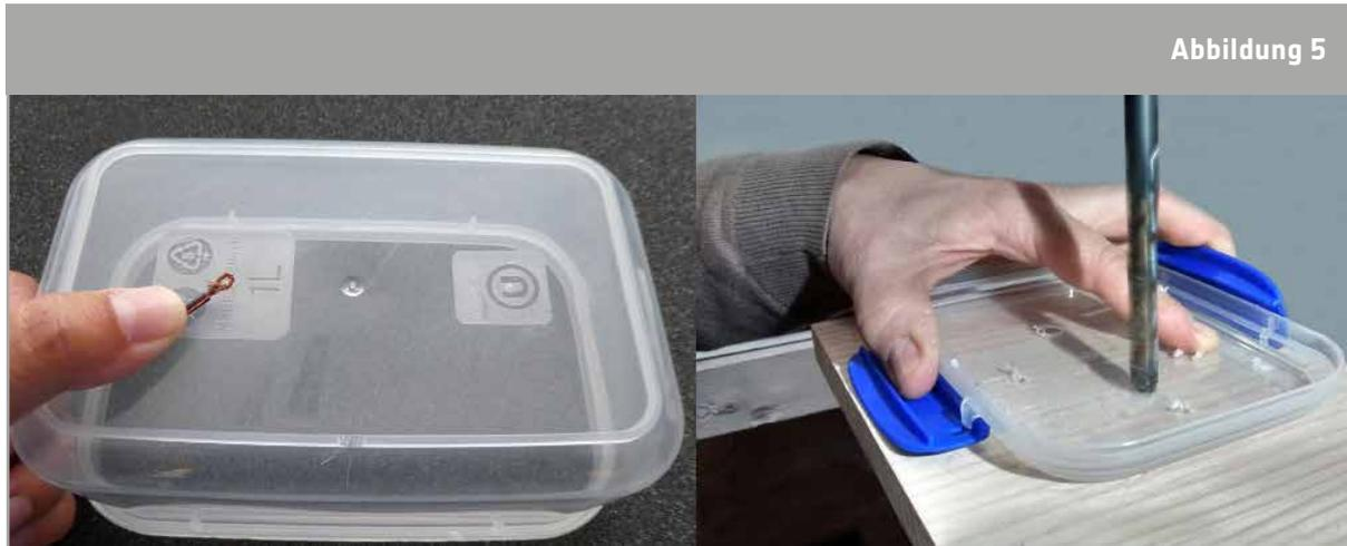
↑ Vorbereitung des Behälters für den Elektrolyseur
