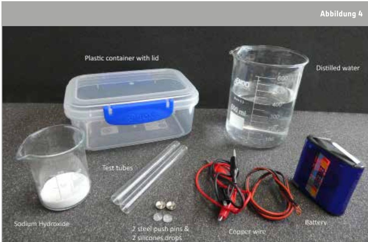
↑ Zum Bau eines Elektrolyseurs benötigtes Versuchsmaterial: Kunststoffbehälter mit Deckel, Reagenzgläser, Destilliertes Wasser, Batterie, Kupferdraht, stählerne Pinnadeln, (Silikon Tropfen), Natriumhydroxid
