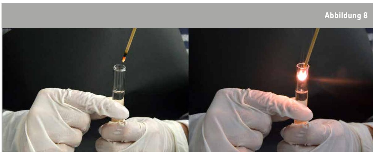
↑ Probe auf Sauerstoff mit angezündetem Span (links). Der Span entzündet sich bei Vorhandensein von reinem Sauerstoff wieder (rechts)
