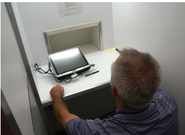
Sensorische Kabine der NASA, in der der Geschmack von Speisen getestet wird. Die Speise wird dem Tester durch einen Schlitz gereicht und die Ergebnisse werden auf einem Computer aufgezeichnet.
