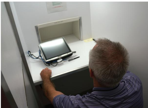
*Cabine sensorielle de la NASA utilisée pour tester le goût des aliments. L'aliment est passé au dégustateur par l'ouverture et les résultats sont enregistrés sur l'ordinateur.*
