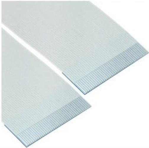
Dieses Band wird verwendet, um die Basisplatine mit der Erweiterungsplatine zu verbinden.
